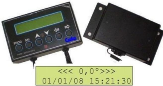
O Inclinômetro é um equipamento opcional oferecido aos clientes RANDON com a finalidade de aumentar a segurança operacional. Sua função principal é monitorar eletronicamente a inclinação lateral da caixa de carga durante o basculamento. Quando este valor ultrapassar um limite pré-estabelecido, o fluxo de óleo para o cilindro é interrompido. Chamamos isso de operação insegura.
